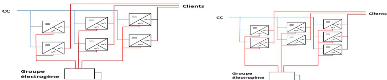
L'ensemble des onduleurs-chargeurs est raccordé à une seule et même batterie (CC), et à un seul et même groupe électrogène.
