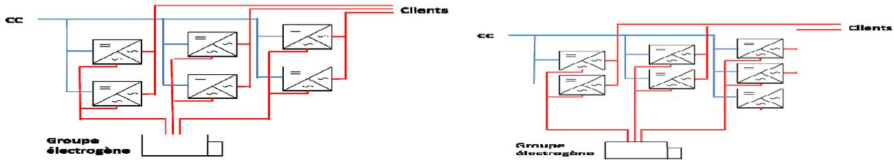
L'ensemble des onduleurs-chargeurs est raccordé à une seule et même batterie (CC), et à un seul et même groupe électrogène.
